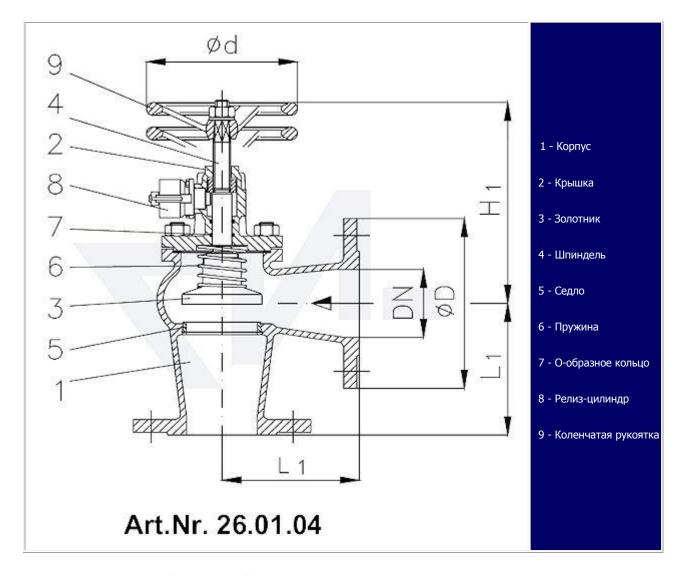
Клапан быстрозапорный фланцевый VG-длина, Gbz 10/Нерж. сталь с цилиндром для пневмо, гидро и под тросовый привод с коленчатой рукояткой для дополнительного запора тип 26.01.04
