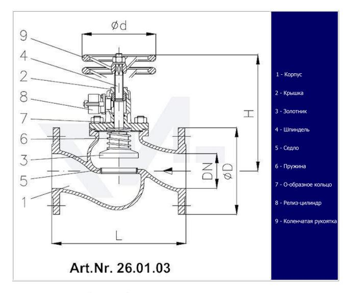
Клапан быстрозапорный фланцевый VG-длина, Gbz 10/Нерж. сталь с цилиндром для пневмо, гидро и под тросовый привод с коленчатой рукояткой для дополнительного запора тип 26.01.03
